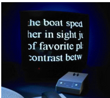
Powiększalnik Zdolność powiększania: 3x do 30x na monitorze 14" oraz 5x do 52x na monitorze 21".
